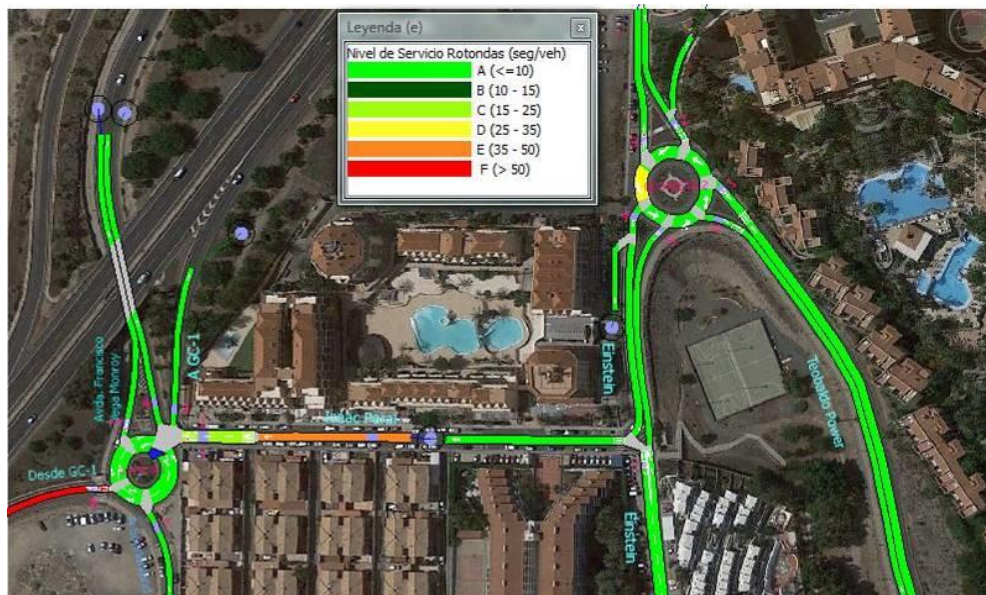
Ilustración 63.- Nivel de Servicio en las Glorietas (segundos que tarda cada vehículo para acceder). Fuente: elaboración propia.
